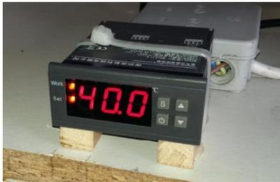
Gemäß Bedienungsanleitung des elektronischen Thermostatschalters wird dieser nun auf eine Maximaltemperatur von 40 °C programmiert und eingeschaltet. Der Fühler im Kühlschrank erfasst die tatsächliche Temperatur der Luft und sobald diese 40 °C erreicht hat schaltet der Thermostat Schalter Glühbirne und Lüfter ab.
